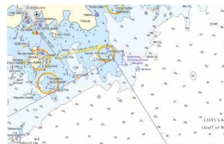
Выдержка из атласа "Морские карты Эстонии" 2022 г. с изображением светового сектора маяка
