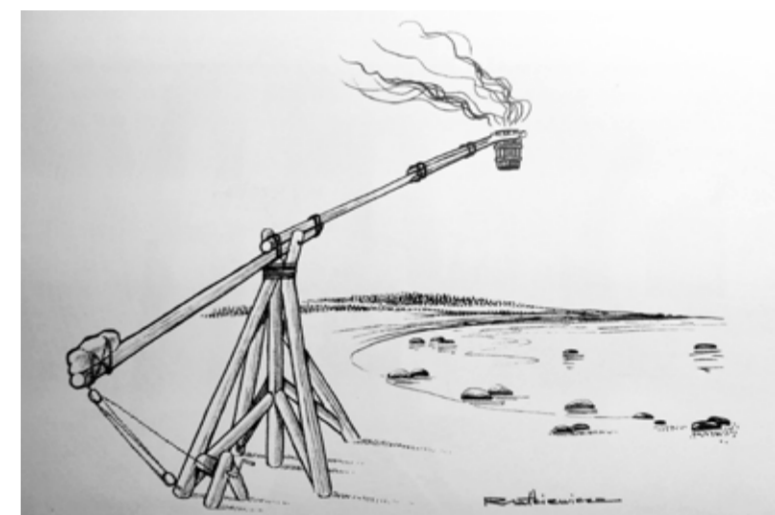
Selline võis välja näha Abruka sihi alumise tulepaagi esimene konstruktsioon elava tulega teraskorvis. Roman Matkiewicz'i joonistus
