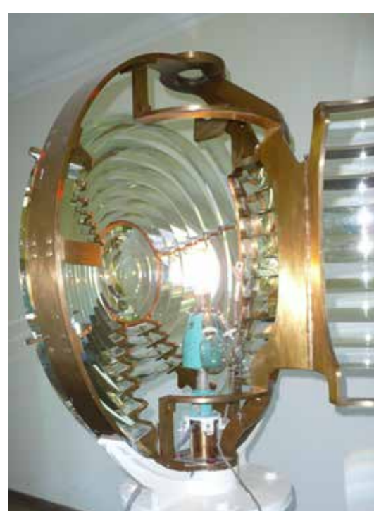
В 1886 г. был установлен катадиоптрический осветительный прибор Френеля третьего порядка фирмы Barbier et Fenestre Constructeurs, фото В. Лайтус
