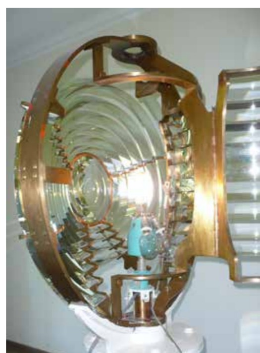
1886. aastal paigaldatud Fresneli 3. järgu katadioptriline valgustusaparaat firmalt Barbier et Fenestre Constructeurs, pildistas V. Laitus
